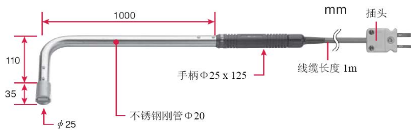
HT-S3热电偶测温探头
